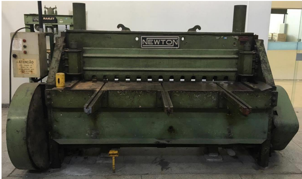
Figura 17 - Guilhotina da marca Newton modelo TM 10
