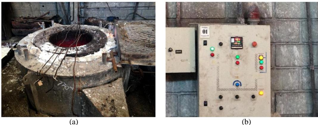
(a): Forno com banho de sal fundido; (b): Termopar para controle da temperatura do banho.
