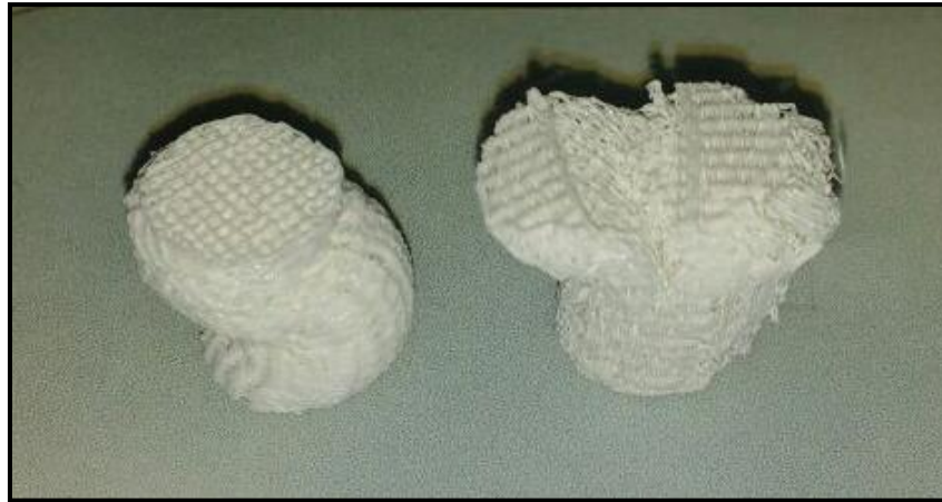
Figura 32: Peças de PLA após ensaio de compressão (arranjo horizontal à esquerda e arranjo vertical à direita)
