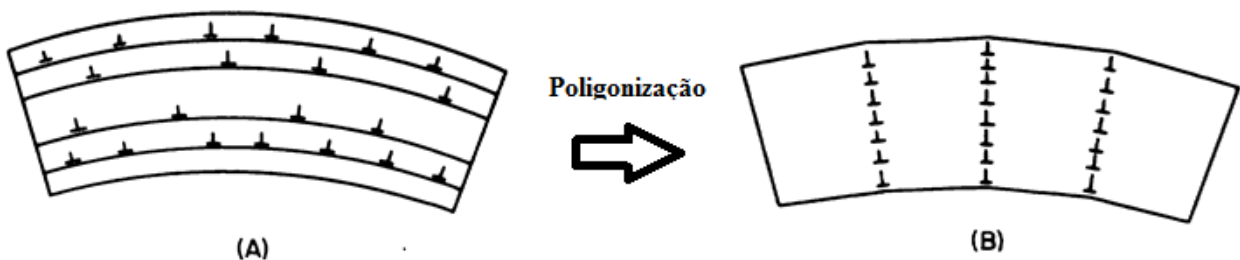
Figura 11 – Representação esquemática de um monocristal que sofreu poligonização
