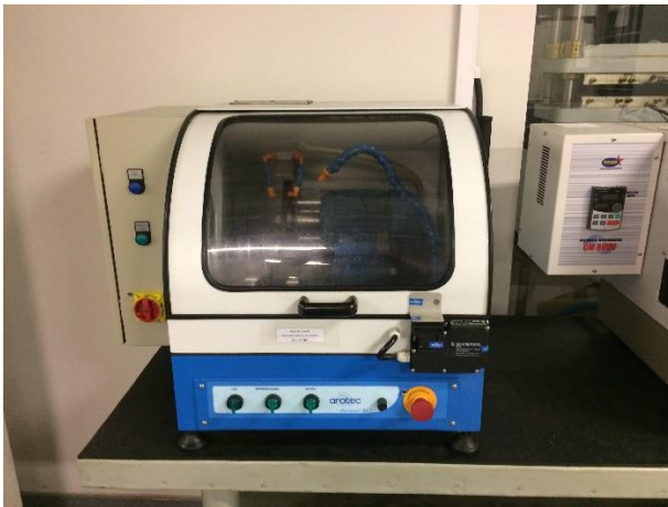
Figura 20 – Máquinas utilizadas para o corte das amostras
