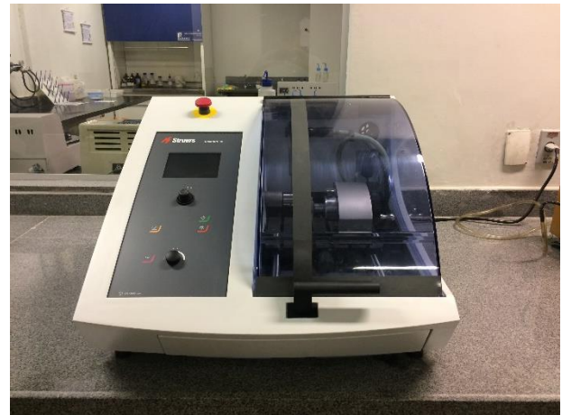
Figura 20 – Máquinas utilizadas para o corte das amostras
