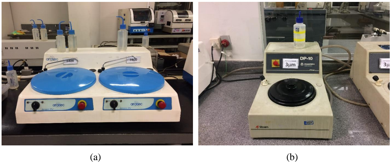
Figura 22 – Máquinas utilizadas na preparação metalográfica
