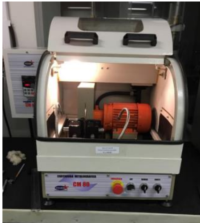
Figura 14 Cortadora Metalográfica CM 80
