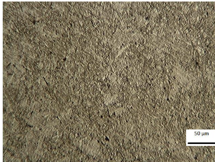
Figura 23 Micrografia amostra tratada à 650°C durante 2h
