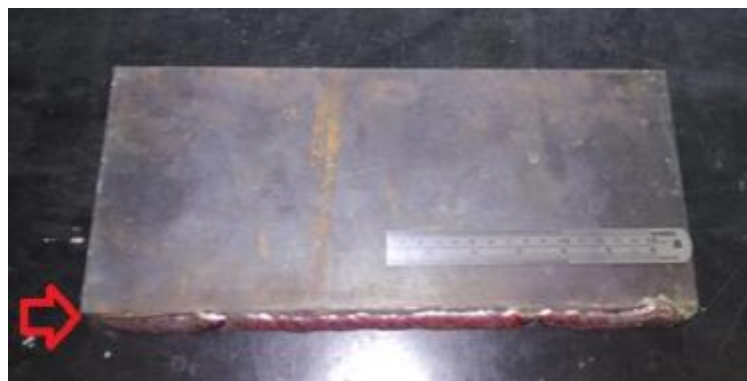
Figura 11 Camada de Amanteigamento
