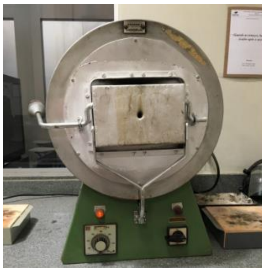
Figura 16 Forno utilizado para revenimento à 600°C durante 8h
