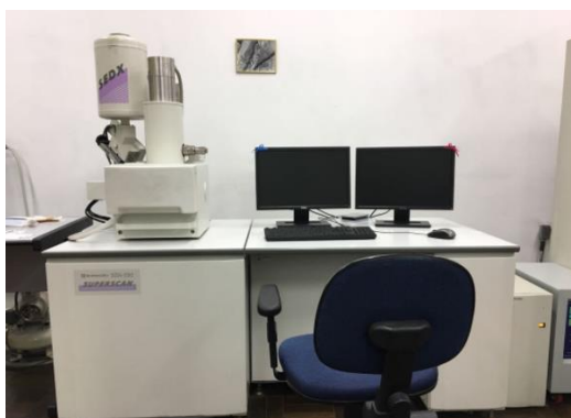
Figura 19 Microscópio Eletrônico de Varredura, Shimadzu, modelo SSX-550
