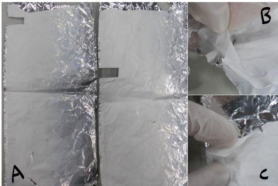
Figura 30 – Eletrofiiação da amostra 3. (A) 20 kV à esquerda e 25 kV à direita. (B) Descolamento da amostra 3-20. (C) Descolamento da amostra 3-25.
