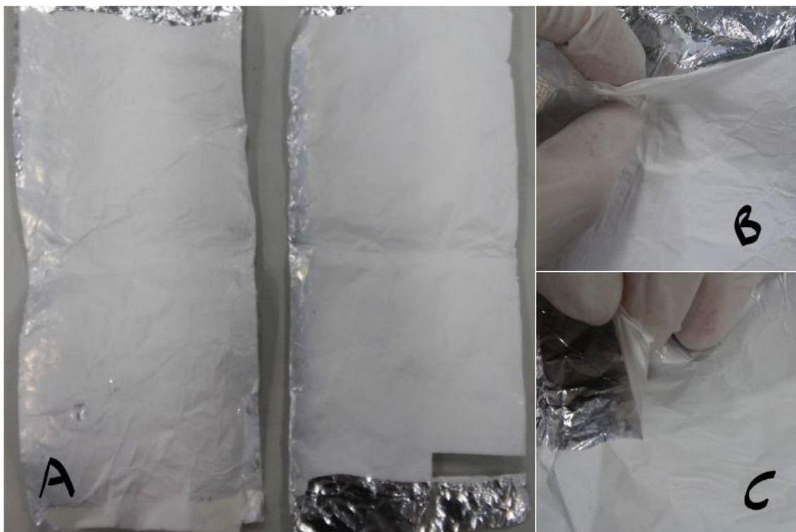
Figura 41 – Eletrofição da amostra 4. (A) 20 kV à esquerda e 25 kV à direita. (B) Descolamento da amostra 4-20. (C) Descolamento da amostra 4-25.
