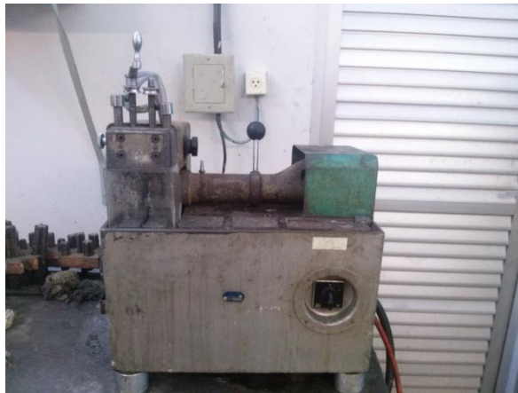
Figura 16 – Cortadora metalográfica utilizada no corte dos corpos de prova.
