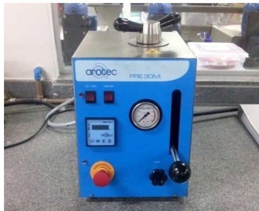
Figura 18 - Prensa de embutimento utilizada no embutimento a quente das amostras.
