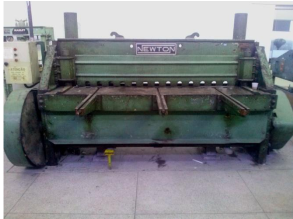
Figura 15 – Guilhotina utilizada no corte dos corpos de prova.
