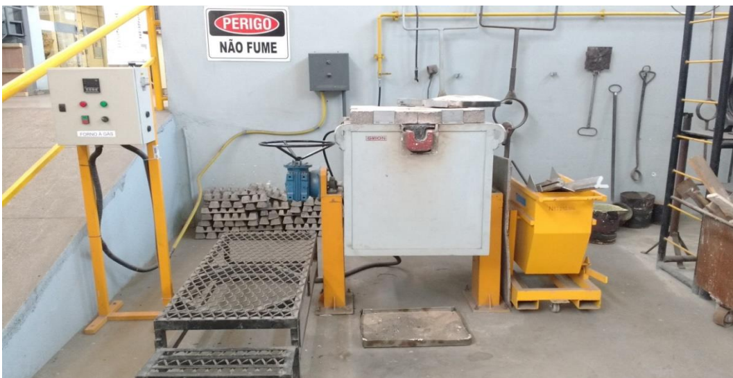
Figura 2. Forno a gás utilizado na fundição do material
