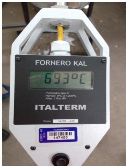
Figura 4. Pirômetro na temperatura de Vazamento
