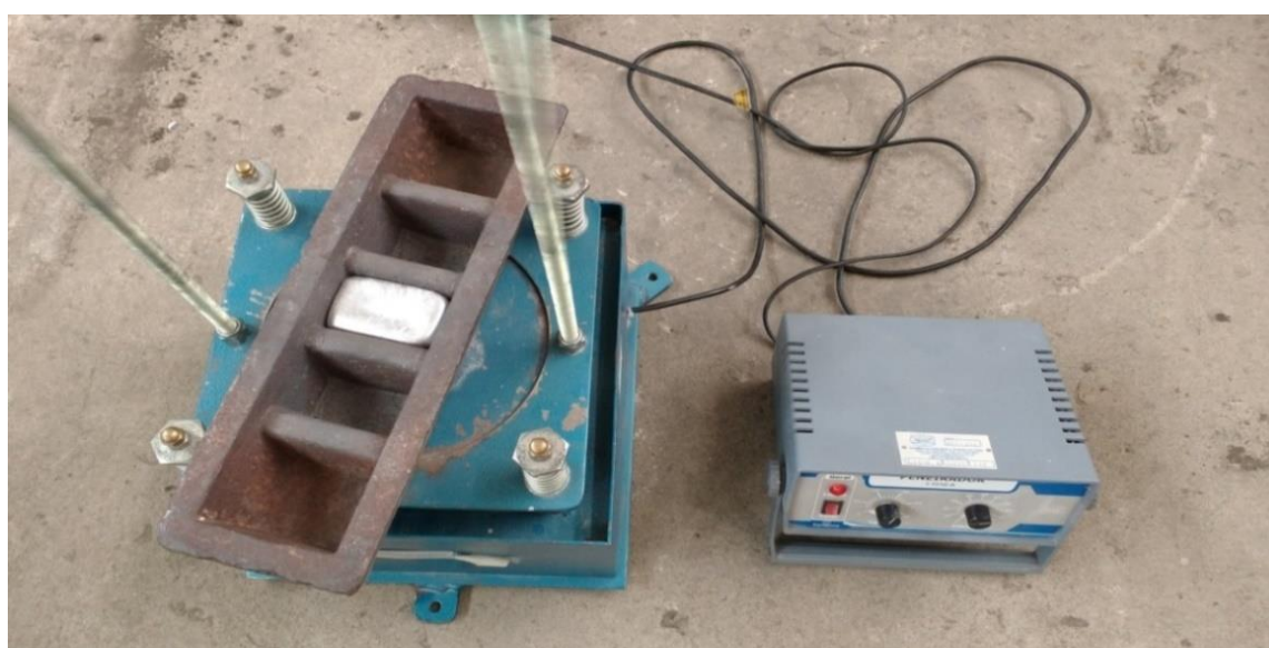
Figura 6. Estrutura de vibração utilizada para o experimento
