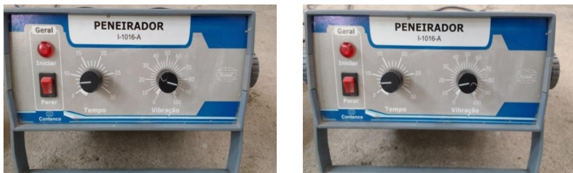
Figura 7. Peneirador usado como aparelho de vibração à 10 e 90 Hertz
