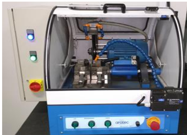
Figura 12. Equipamento usado para contar os corpos de prova em cubos 10mm x 10mm
