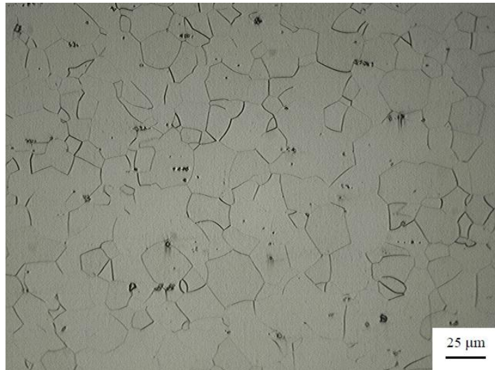
Figura 11- Micrografia do aço AISI 444 com aumento de 400x
