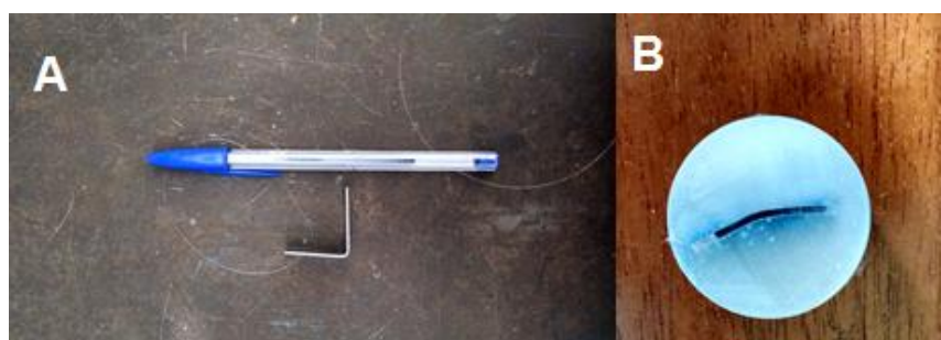
Figura 9– A – Chapa após dobramento a 90° B- Chapa embutida em Acrílico e lixada
