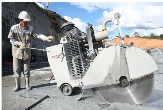
Figura 07 – Processo de arranque da ardósia.
