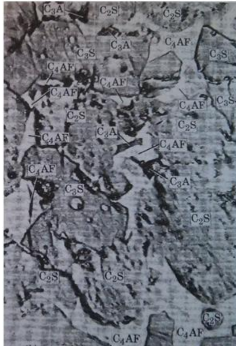
Figura 01 – Micrografia do cimento Portland.
