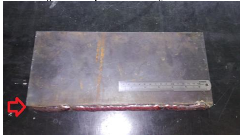
Figura 13 - Chapas 1 com amanteigamento
