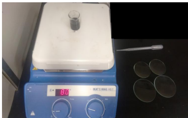
Figura 8 - Agitador Magnético, vidro de relógio e pipetador utilizados no preparo das amostras de PANi.
