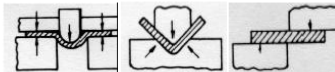
Figura 20 - Representação esquemática das operações de estampagem por estampagem profunda, dobramento e corte, respectivamente.
