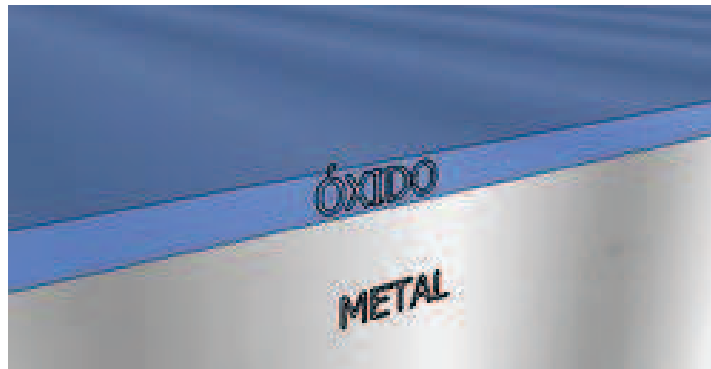
Figura 3.14 - Representação esquemática da liga líquida na parte inferior e o óxido de seu metal, menos denso, na parte superior
