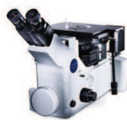
Figura 4.12 - Microscópio utilizado para visualização da microestrutura do material
