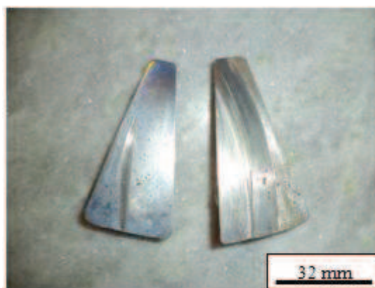
Figura 5.16 - Amostra obtida após vazamento em proveta e resfriada ao ar
