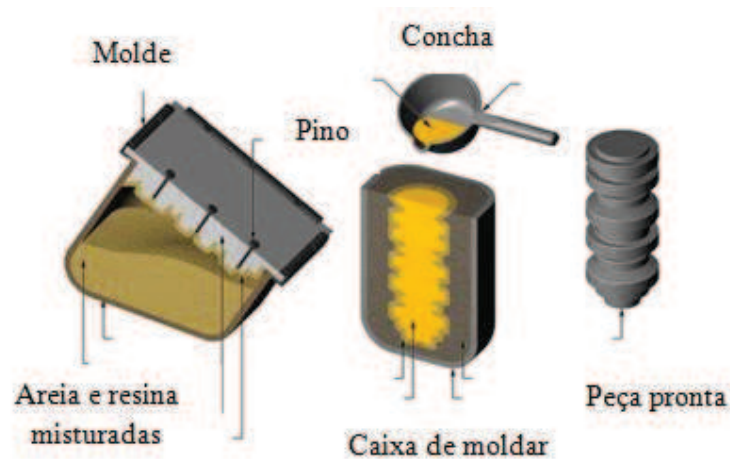
Figura 3.4 - Processo de fundição em casca, também denominado shell mold
