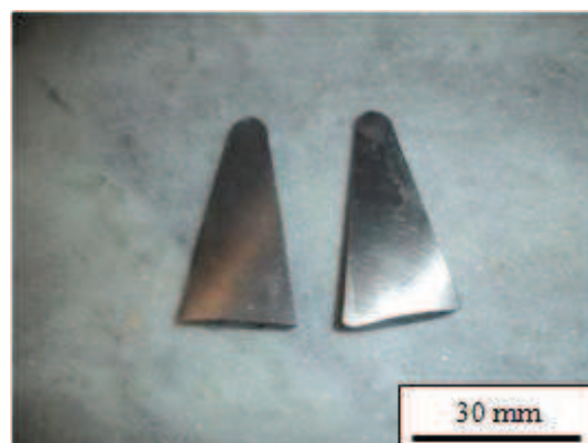
Figura 5.12 - Amostra obtida após vazamento em proveta embutida em molde de areia e resfriada ao ar
