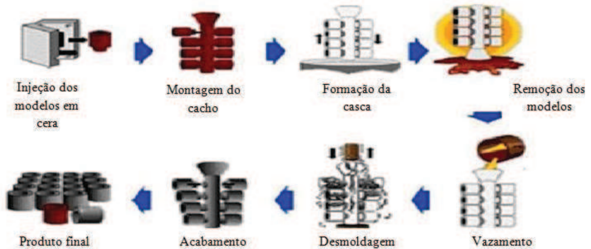
Figura 3.5 - Esquema do processo de fundição utilizando moldagem em cera perdida
