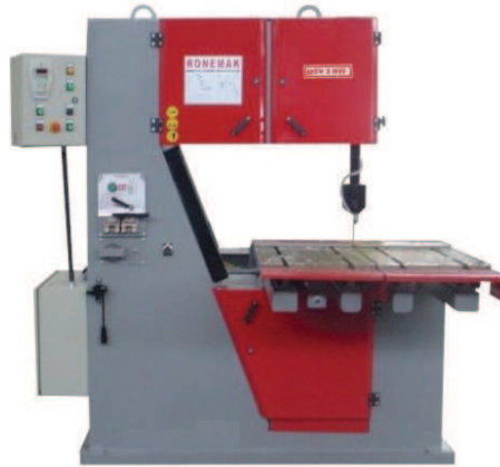
Figura 4.8 - Serra de fita utilizada para o corte das peças em análise
