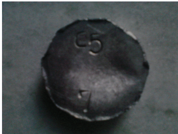
Figura 4.5 - Amostra coletada antes de vazar os cabeçotes para realização de análises químicas e metalográficas
