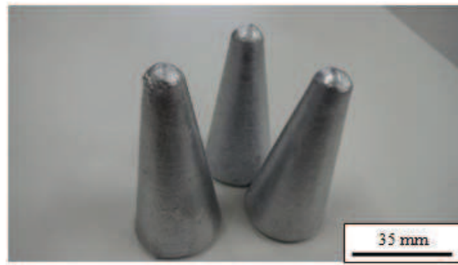
Figura 5.11 - Amostras obtidas após vazamento e resfriamento
