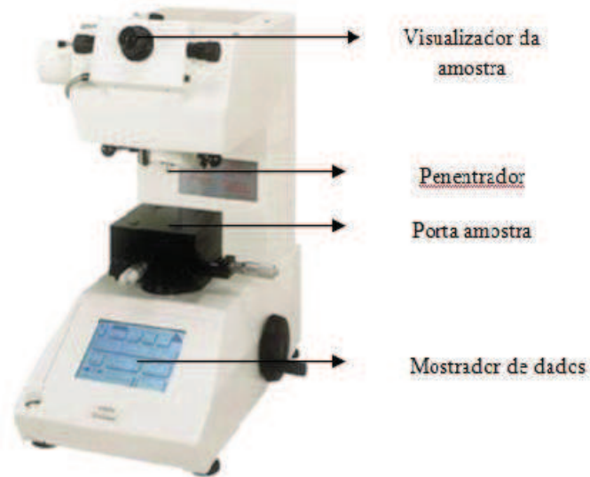
Figura 4.14 - Microdurômetro Shimadzu utilizado na medição de microdureza
