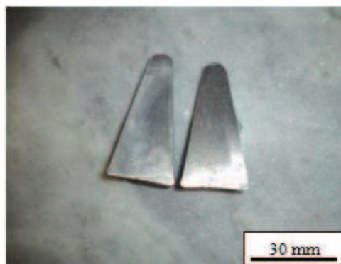
Figura 5.14 - Amostra obtida após vazamento em proveta embutida em molde de areia e resfriada em água corrente
