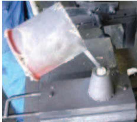
Figura 3.10 - Esquema de vazamento em coquilha
