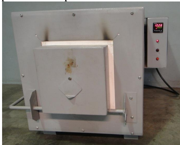
Figura 2 - Equipamento utilizado para tratamentos térmicos: forno elétrico Magnus
