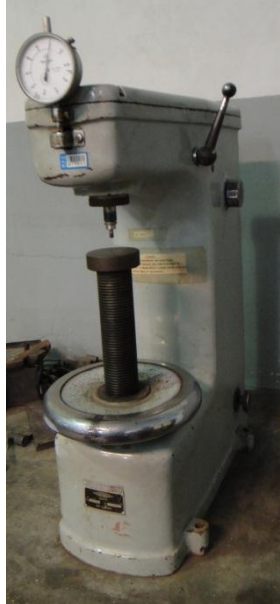
Figura 3 - Equipamento utilizado para ensaio mecânico: durômetro IGV
