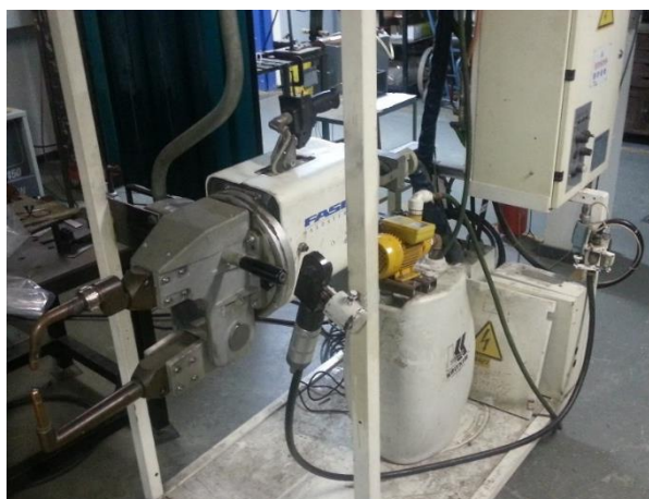
Figura 16 - Equipamento utilizado para a realização das soldas.
