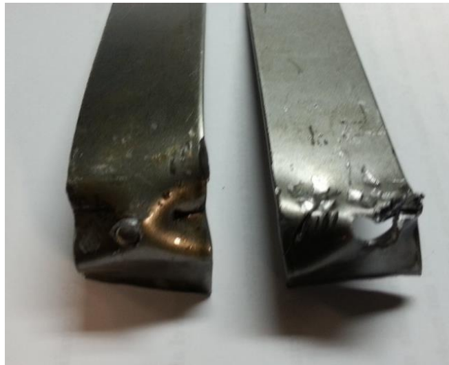
Figura 27 - Resultado do ensaio da arrancamento para validação dos parâmetros
