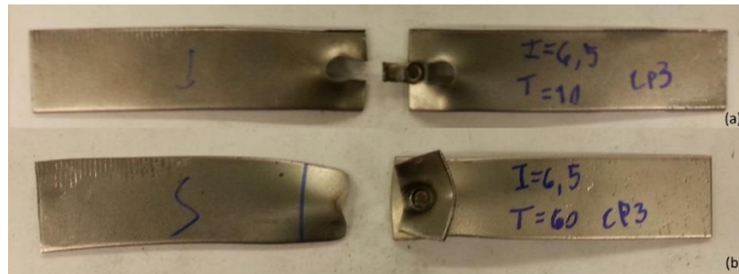
Figura 44 - Comparativo de fratura: (a) Corpo-de-prova T=10 CP3 do terceiro procedimento de testes, (b) Corpo-de-prova T=60 CP1 do terceiro procedimento de testes.
