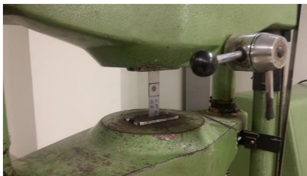
Figura 30 - Foto do posicionamento dos corpos-de-prova no ensaio de tração
