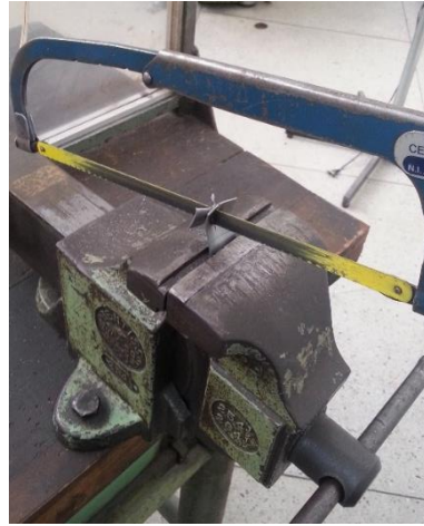
Figura 31 - Corte dos corpos-de-prova para confecção de amostras para o ensaio metalográfico
