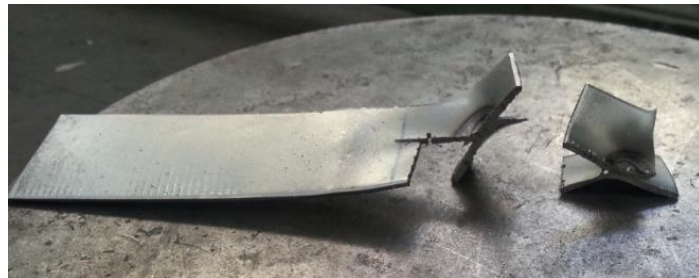
Figura 32 - Corpo-de-prova após corte através do ponto de solda
