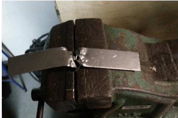
Figura 26 - Teste de arrancamento para validação dos parâmetros de solda
