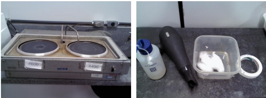
Figura 16: Materiais utilizados no lixamento: a) lixadeira politriz; b) materiais para limpeza e secagem da peça.
