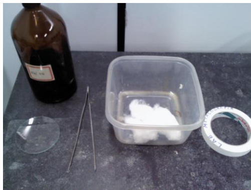
Figura 17: Materiais utilizados para o ataque químico (Nital 3%).
