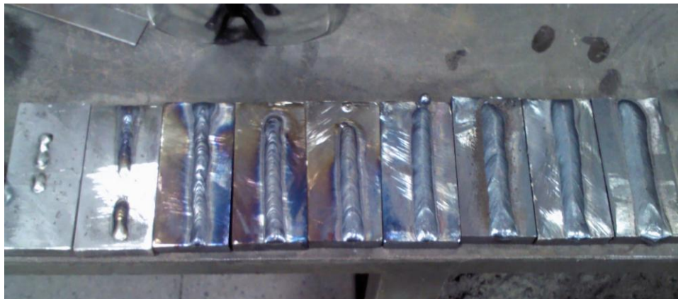
Figura 21: corpos de prova soldados: a) chapas enumeradas de 1-9; b) chapas enumeradas de 10-18
