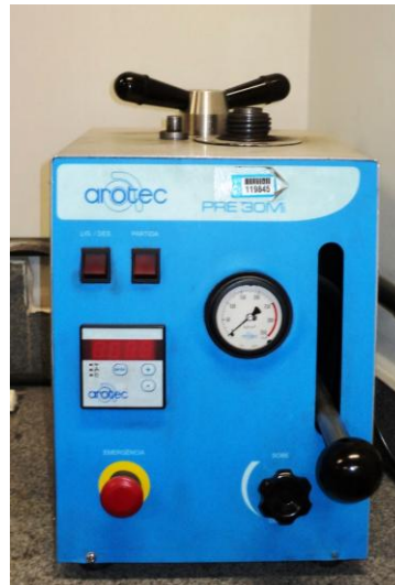
Figura 4.8 – Máquina de embutimento a quente do Laboratório de Metalografia do Departamento de Engenharia de Materiais do CEFET-MG
