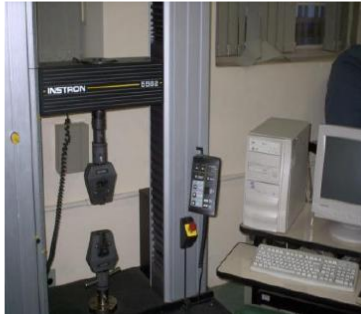
Figura 4.2 – Máquina de ensaios universais INSTRON 5582 do Departamento de Engenharia Metalúrgica da UFMG
