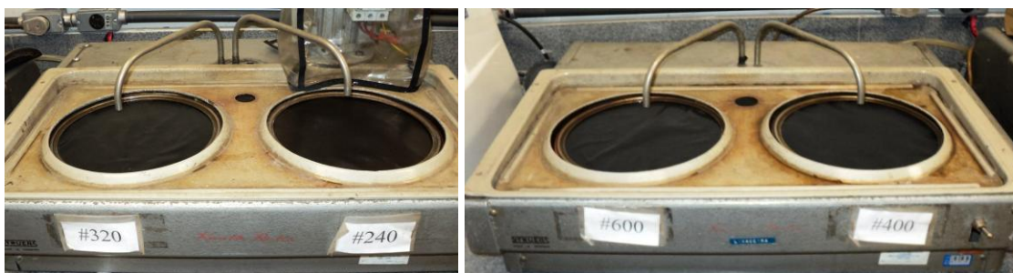
Figura 4.9 – Lixadeiras do Laboratório de Metalografia do Departamento de Engenharia de Materiais do CEFET-MG
