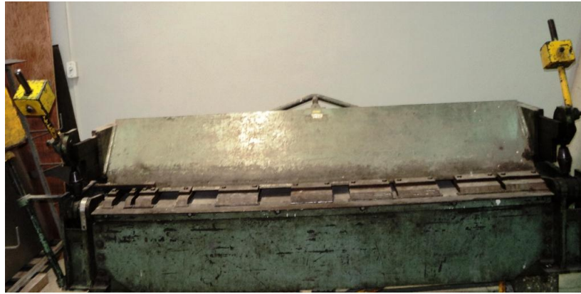
Figura 4.6 – Dobradeira mecânica do Laboratório de Calderaria do Departamento de Engenharia de Materiais do CEFET MG
