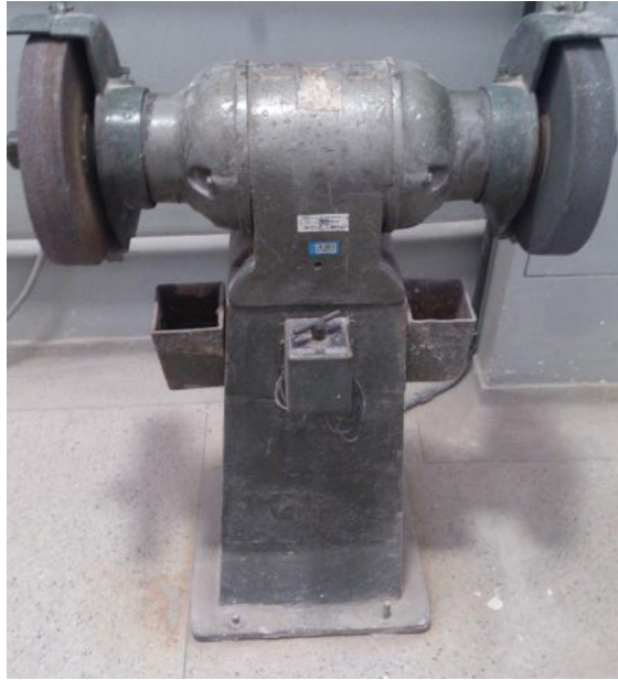
Figura 23 - Esmeril utilizado para preparação dos corpos de prova
