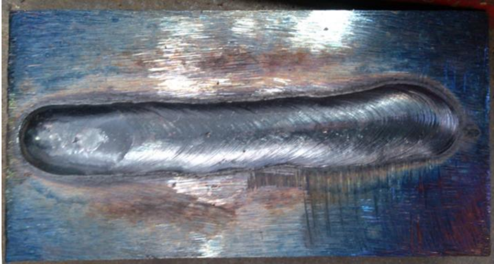
Figura 27 - Corpo de prova de aço A36 após soldagem a arco submerso
