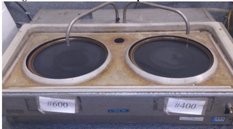
Figura 32 - Lixadeira utilizada para lixar as amostras
