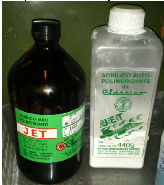
Figura 29 - Co-polímeros utilizados para embutimento a frio
