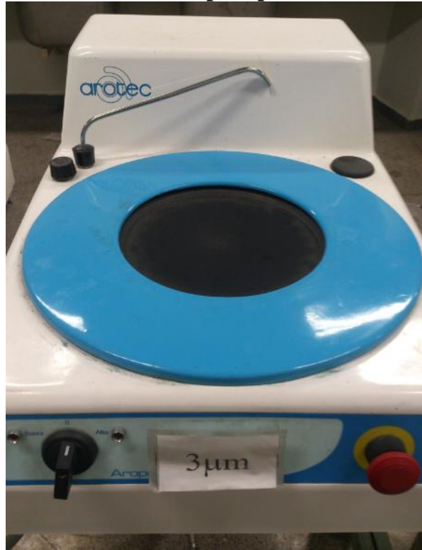
Figura 33 - Politriz utilizada para polir as amostras controle
