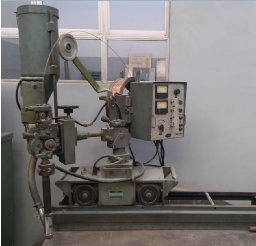
Figura 24 - Equipamento para soldagem a arco submerso do CEFET-MG
