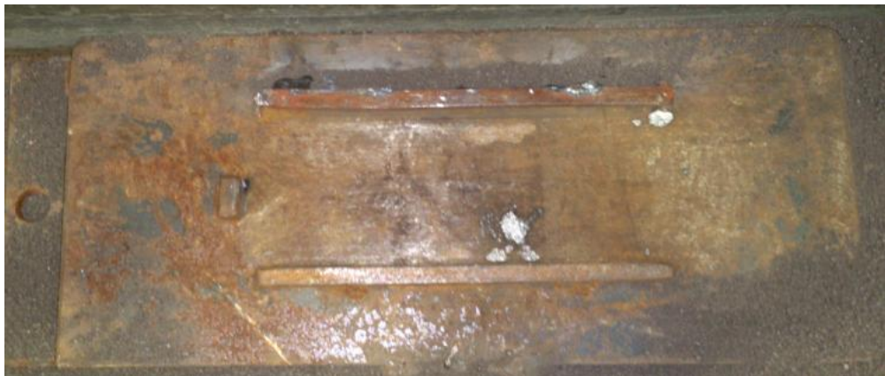
Figura 25 - Gabarito utilizado durante a soldagem a arco submerso
