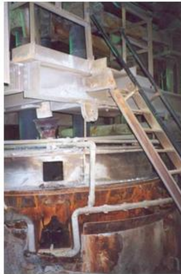
Figura 16 - Forno elétrico utilizado para a fabricação de fluxo fundido
