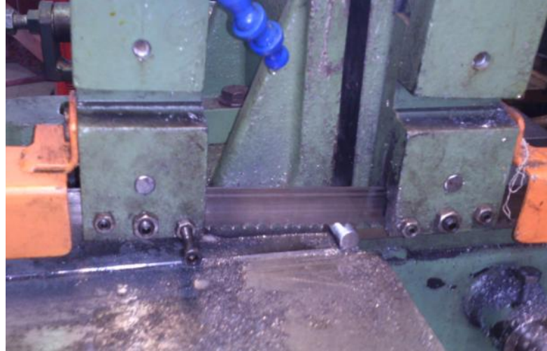
Figura 31 - Serra do equipamento utilizado para corte dos corpos de prova
