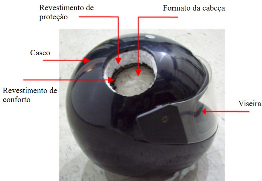
Figura 16 - Típico capacete e suas estruturas internas.
