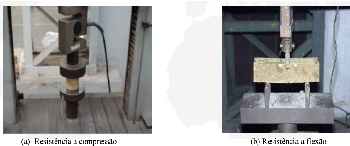
Figura 6 Ensaio de resistência mecânica
