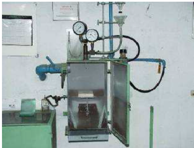
Figura 9 Equipamento para ensaio de resistência a abrasão
