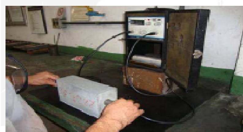
Figura 7 Teste de ultrassom em refratários;
