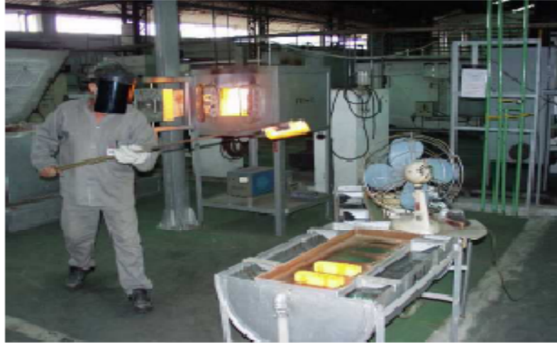
Figura 8 Resistência ao choque térmico com resfriamento ao ar em placas refrigeradas
