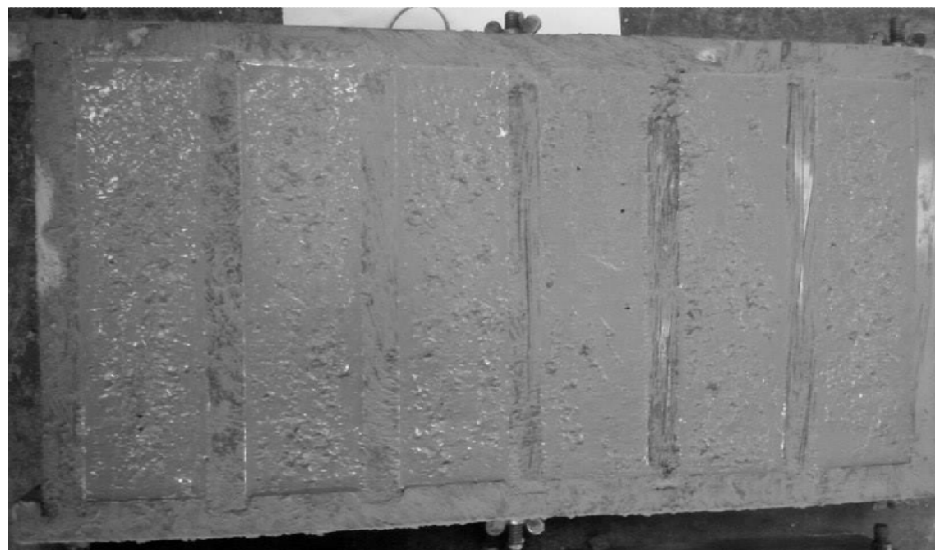
Figura 3 Corpos de prova prismáticos 40x40x160mm
