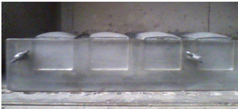
Figura 14 Concreto Geop.1 expandido após cura a 45°C
