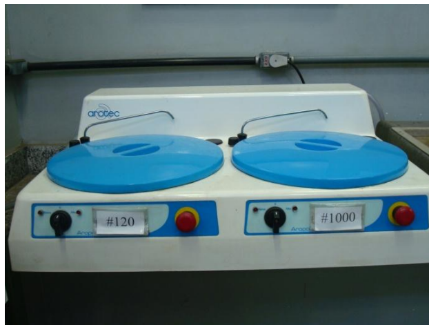
Figura 22: Lixadeira/politriz marca Arotec utilizada no trabalho.
