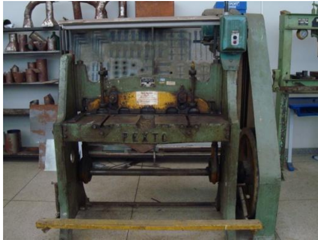
Figura 20: Guilhotina da marca Pexto empregada no corte das amostras.
