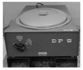
Figura 11 – Politriz manual utilizada para preparação metalográfica.
