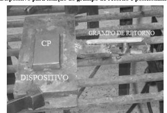
Figura 13 – Dispositivo para fixação do grampo de retorno e posicionamento dos CPs.
