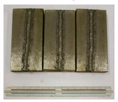
Figura 19 – Cordões de solda realizados com o eletrodo E 6013 (3,25 mm de diâmetro e polaridade negativa no eletrodo).
