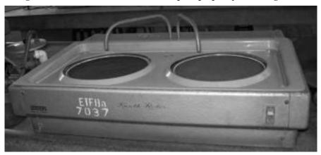
Figura 10 – Lixadeira manual utilizada para preparação metalográfica.
