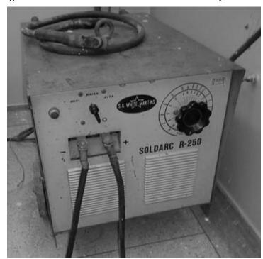
Figura 9 – Fonte de corrente contínua utilizada nos experimentos.
