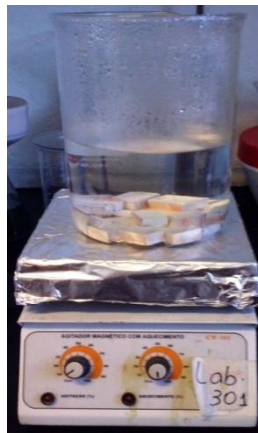
Figura 16 – Amostras em água fervendo para medir o teor de absorção de água.
