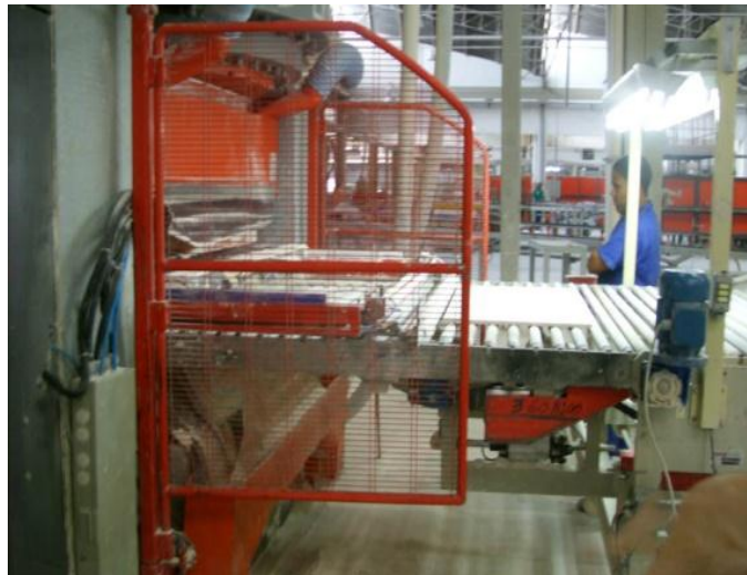
Figura 5 - Esteira na empresa Cecrisa, onde a peça já é prensada no formato estabelecido.
