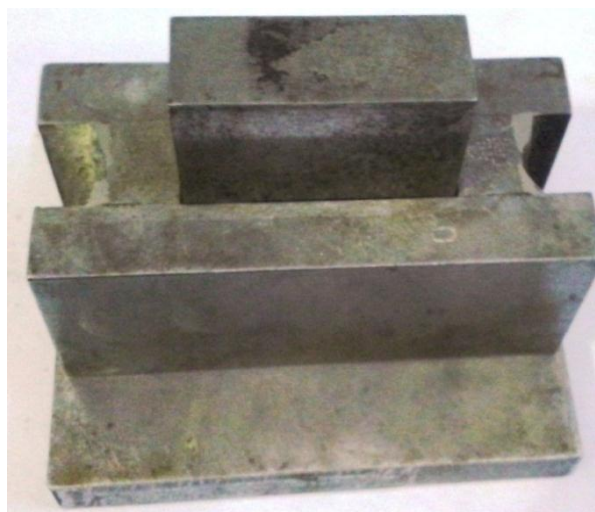
Figura 13 - Molde utilizado para a fabricação dos corpos de prova.
