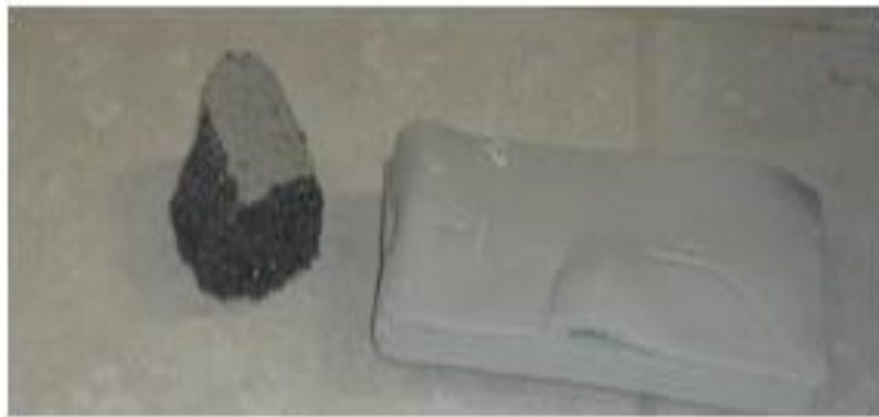
Figura 10 - Amostras de RPP expandidas na Cecrisa após serem inseridas no processo produtivo de porcelanato.
