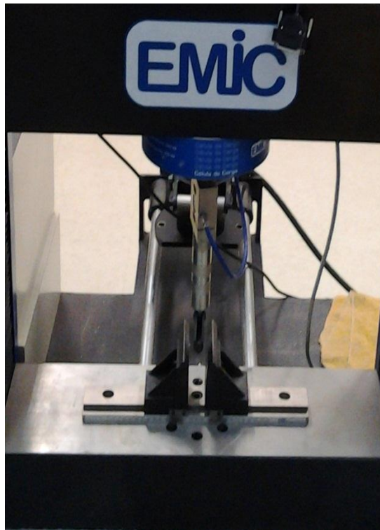
Figura 20 – Máquina utilizada para ensaio de flexão (EMIC DL-30000).
