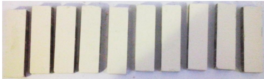
Figura 17 – Corpos de prova do RPP prensados para a temperatura de sinterização de 1.050°C.
