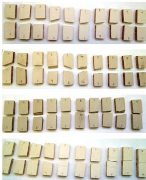
Figura 27 - Amostras de resíduo à temperatura de sinterização de 1.000°C, 1.050°C e 1.100 °C e da massa comercial atomizada, respectivamente, fraturadas após ensaio de flexão.
