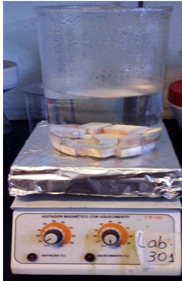
Figura 21 – Amostras em água fervendo para medir o teor de absorção de água.
