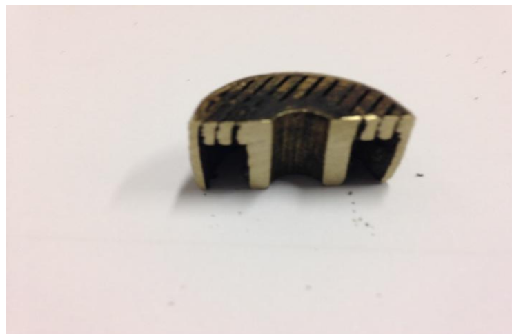
Figura 9 - .(a) Vista Superior de uma amostra de respiro, cortada na parte central para melhor visualizar as regiões de aderência da mistura às paredes do respiro.
