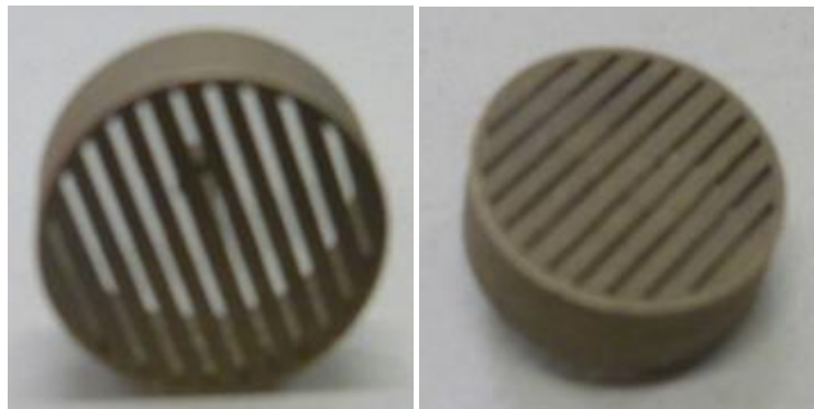
Figura 4 - (a) Vista traseira e frontal, respectivamente de respiros utilizados nas caixas de macho para atender aos processos.
