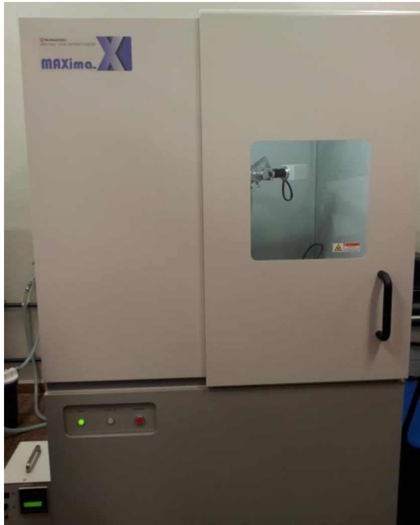
Figura 28 – Difratorômetro utilizado para a realização do ensaio de difração de raio-x
