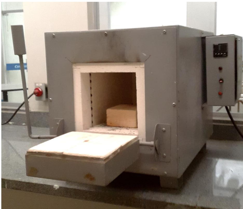
Figura 23 - Forno no qual os tratamentos térmicos foram realizados
