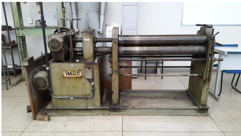
Figura 24 - Máquina na qual a calandragem das amostras foi realizada
