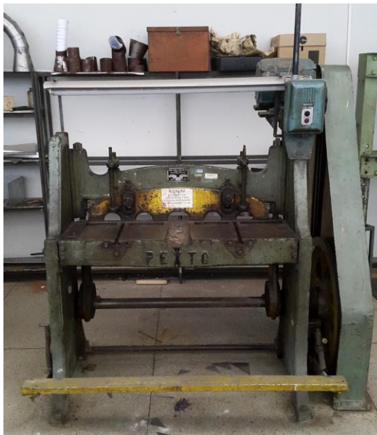
Figura 22 – Guilhotina usada no corte das amostras a partir da chapa
