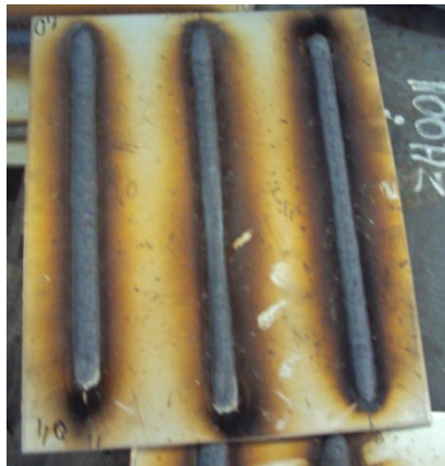
Figura 19 - Chapa de aço duplex SAF 2205 soldada com aporte térmico de 1 kJ/mm.
