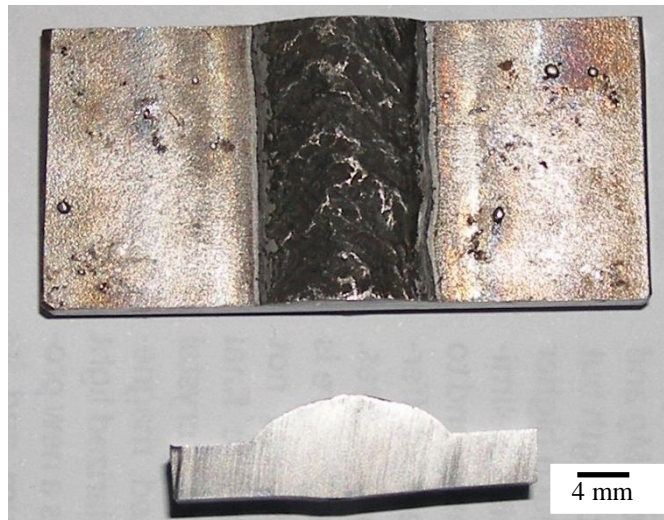
Figura 20 - Amostras retiradas da seção transversal das chapas contendo o MB, ZTA, ZF.
