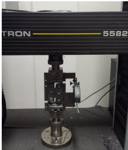
Figura 36 – Máquina de ensaios universais Instron 5582 com a garra de cisalhamento adaptada.
