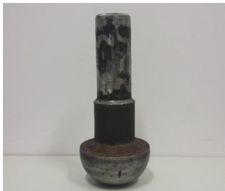
Figura 32 – Punção utilizado para confecção dos copos estampados.
