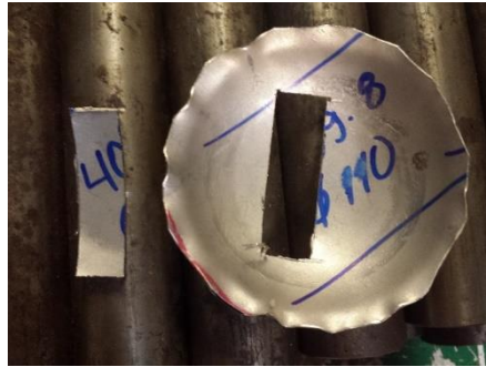
Figura 29 – Corte do corpo de prova obtido para o ensaio de cisalhamento planar simples.
