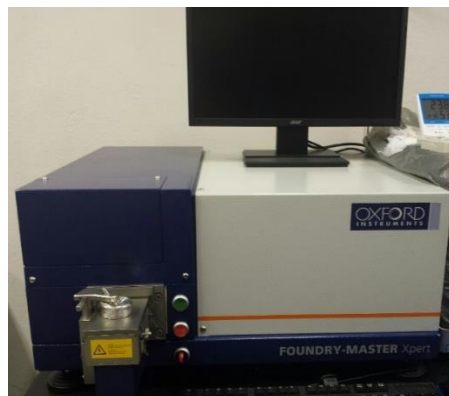
Figura 18 – Equipamento utilizado para análise química do aço inoxidável ferrítico AISI 409.
