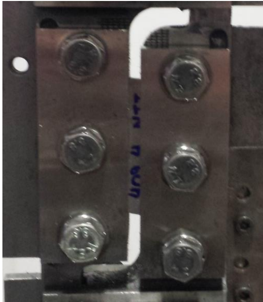
Figura 37 – Corpo de prova do ensaio de cisalhamento planar simples já preso a garra de cisalhamento.
