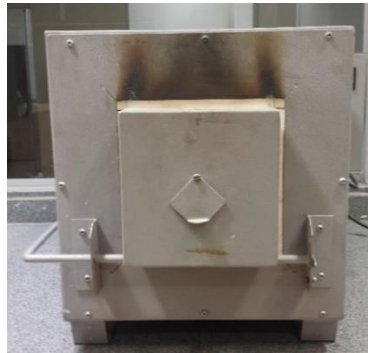
Figura 24 – Forno elétrico da marca Magnus utilizado na realização do tratamento térmico.
