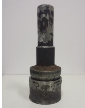
Figura 34 – Conjunto matriz e punção utilizados para confecção dos copos estampados.
