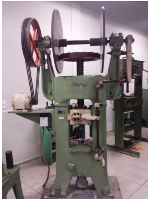
Figura 31 – Prensa mecânica Gutmann utilizada para confecção dos copos estampados.
