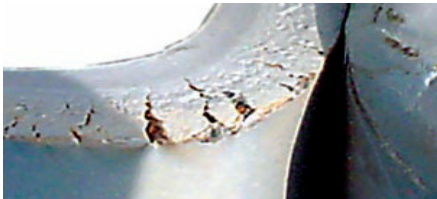
Figura 5 – Trincas causadas pelo dobramento de um aço com alta resistência mecânica.
