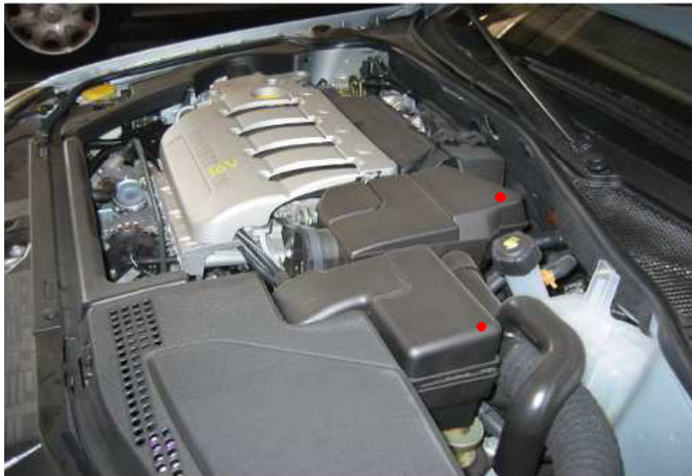
Figura 9 – Tampa do filtro de ar feita de PP + EPDM + Talco.
