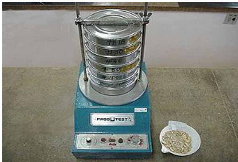
Figura 4 - Peneirador mecânico para classificação granulométrica
