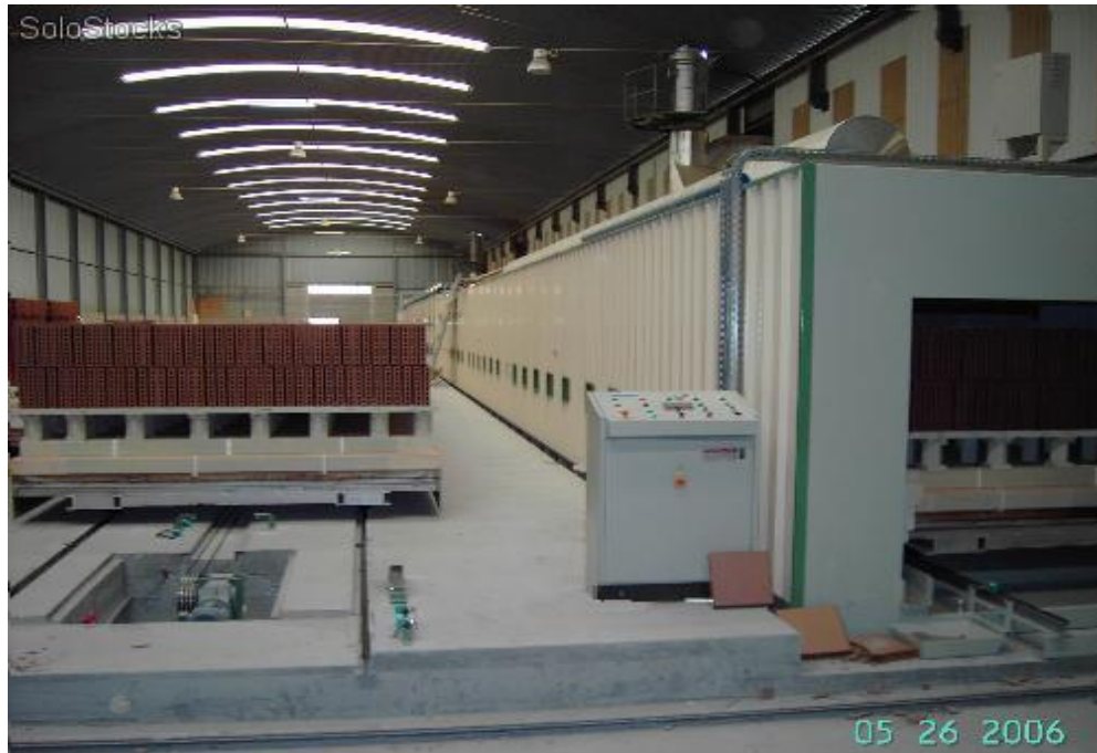
Figura 14 - Forno Túnel para sinterização
