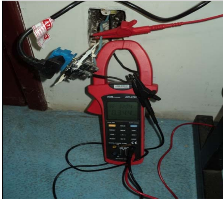
Figura 21- Alicates wattímetro medidor de energia ICEL, modelo AW-4700
