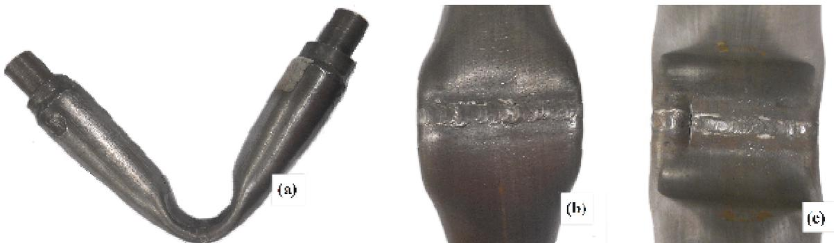
Legenda: (a) e (b) Imagens de CP 08 após o ensaio de dobramento. (c) Imagem de CP 08 após ensaio de dobramento evidenciando fratura perpendicular ao cordão de solda.
