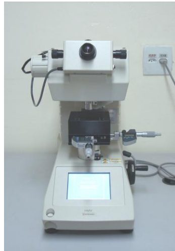
Figura 17 – Microdurômetro Shimadzu – modelo 2T utilizado para realização do ensaio de dureza.
