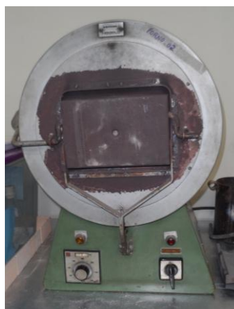
Figura 18 – Forno Brasimet utilizado para realização dos tratamentos térmicos.
