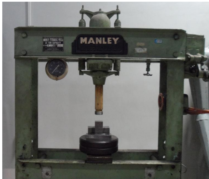
Figura 19 – Prensa hidráulica utilizada para deformar através de compressão os corpos de prova.
