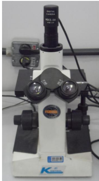
Figura 15 – Microscópio óptico da marca Fortel utilizado para digitalizar as fotomicrográficas ópticas.
