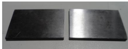
Figura 20 – Gabaritos utilizados como “fim de curso” para a deformação por compressão.
