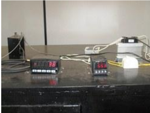
FIGURA B.1 - Display da célula de carga.
