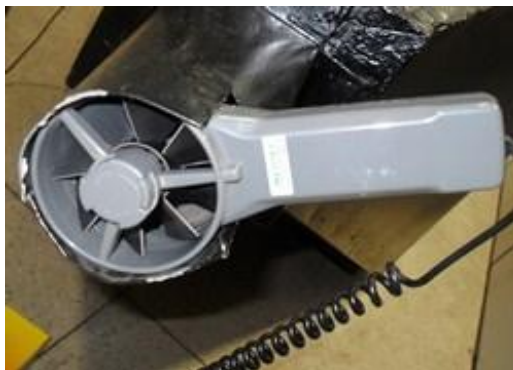
FIGURA B. 5 - Ventoinha do anemômetro na entrada do secador.
