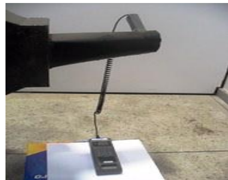
FIGURA B.6 - Anemômetro acoplado na entrada do secador.
