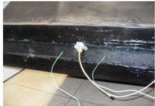
FIGURA B.4 - Termopares tipo "K" na saída do secador.
