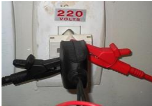
FIGURA B.3 - Jacarés do Wattímetro conectados nas fases.
