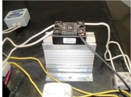
FIGURA B.2- Relé do sistema PID.
