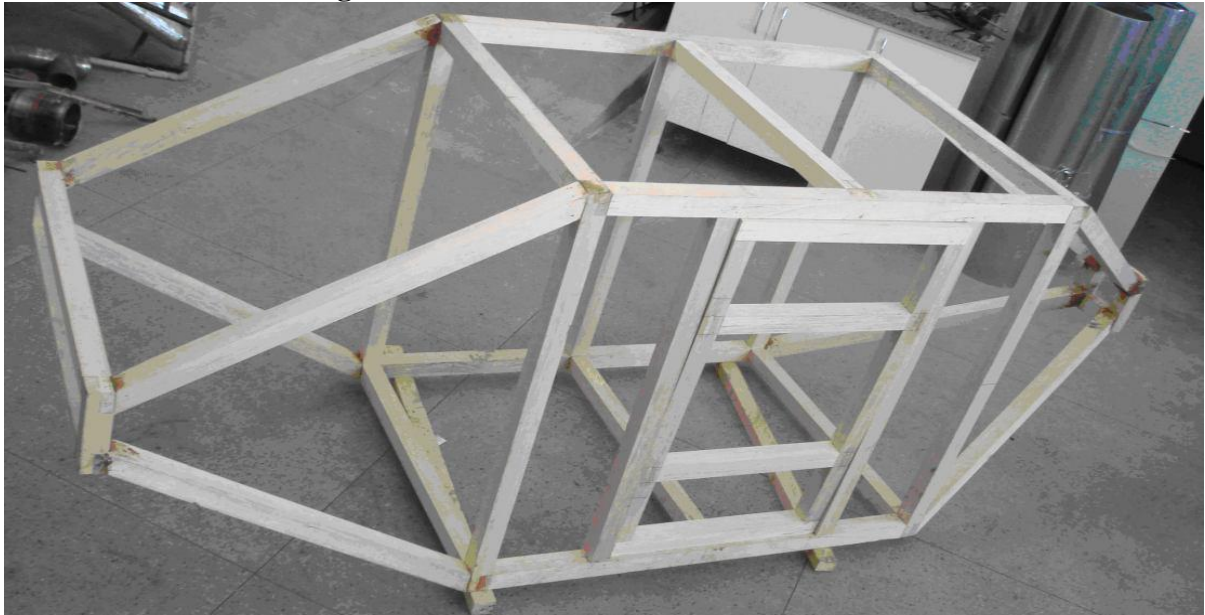
Figura 1 - Estrutura de madeira em caixeta
