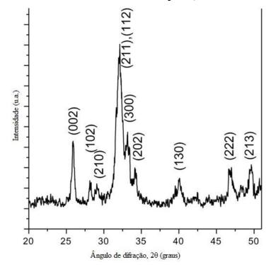
Figura 31 - Padrão de DRX de uma hidroxiapatita, obtido na literatura.
