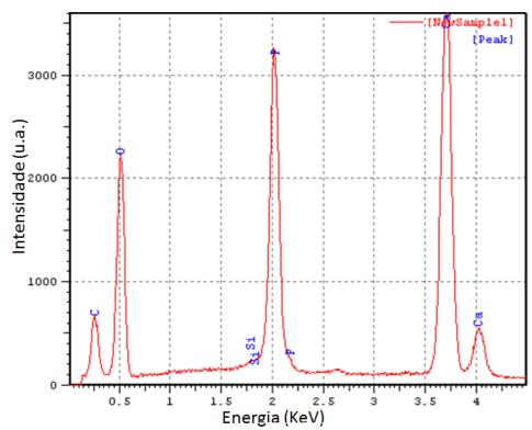
Figura 28 - Espectro de EDS mostrando picos referentes aos elementos detectados na HA estudada.
