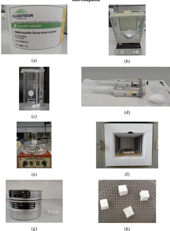
(a) pó de HA utilizado nos experimentos, (b) balança para pesagem da massa de HA, (c) backer e agitador magnético, (d) pipetas volumétricas automáticas, espátula e a massa de HA, utilizada na suspensão, (e) equipamentos utilizados na homogeneização da pasta de HA, (f) amostras, sobre uma base de alumina, dentro do forno usado no tratamento térmico, (g) conjunto de peneiras, utilizado para delimitar o tamanho dos grânulos, (h) grânulos sobre uma peneira antes do corte.
