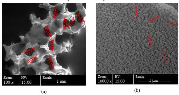
Figura 35 - Imagens dos grânulos de HA, obtidas por MEV, destacando medidas de macroporosidade e mesoporosidade.
