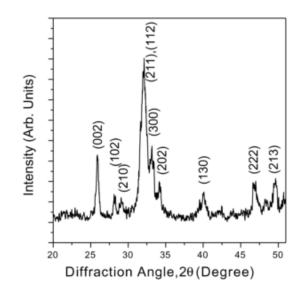
Figura 10 - Padrão de difração de raios-X para a hidroxiapatita.
