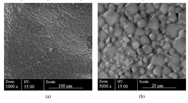
Figura 34 - Imagens de microscopia eletrônica de varredura dos grânulos de HA.
