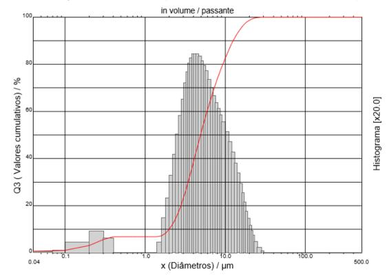
Figura 26 - Distribuição granulométrica da partículas de HA, analisadas com o uso de dispersante.
