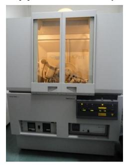
Figura 23 - Equipamento utilizado na difração de raio X.
