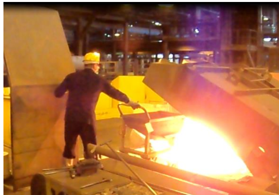
Figura 20- Etapas de correção química do metal.
