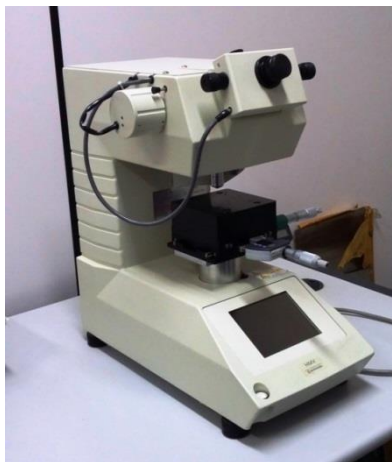
Figura 29- Microdurômetro Vickers utilizado no ensaio.
