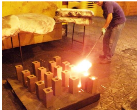
Figura 21 - Vazamento do metal em moldes
