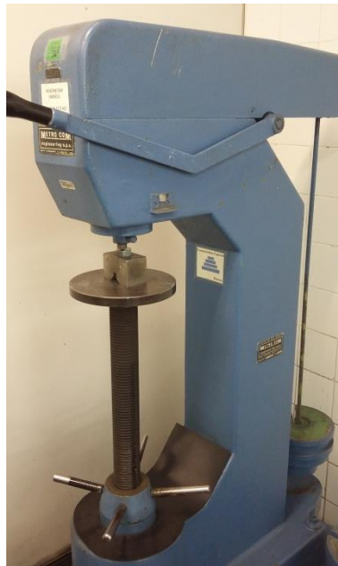
Figura 30- Durômetro Brinell utilizado no ensaio
