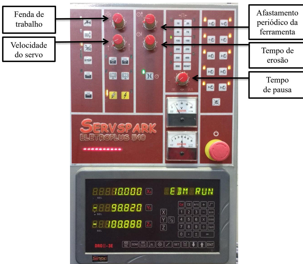
Figura 4. Fotografia do painel de controle da máquina de eletroerosão Servspark Eletroplus EDM-540.
