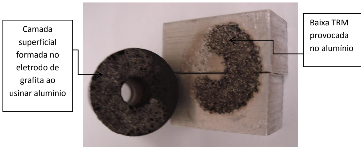
Figura 22- Eletrodo de grafita com uma camada superficial e peça de alumínio usinada.
