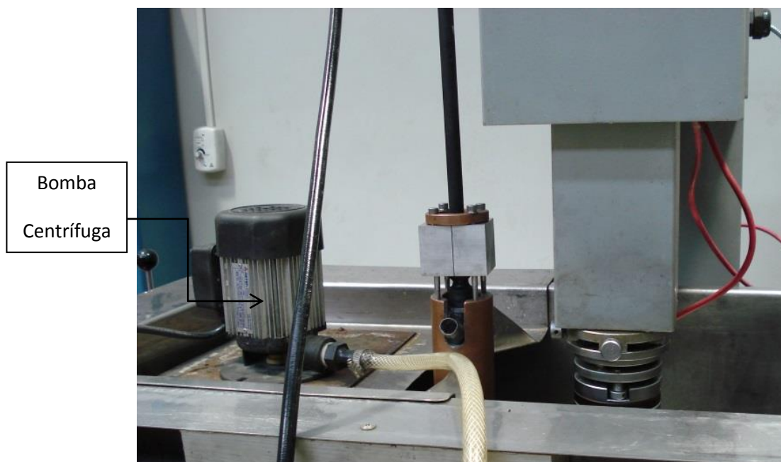
Figura 15 – Bomba centrífuga para esvaziamento de água mais abrasivo da cuba.
