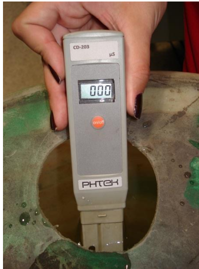
Figura 17– Medição da condutividade da água deionizada através do condutivímetro.
