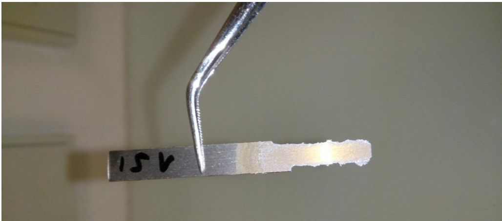
Figura 17 - Corrosão da amostra 9 anodizada com tensão de 15V e tempo de 5min.
