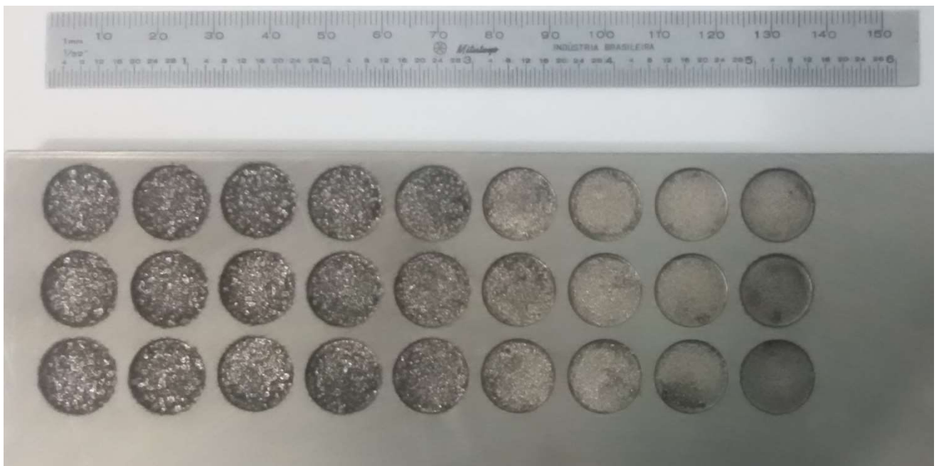
Figura 23 - Barra chata de aço AISI 304 usinada por EDM
