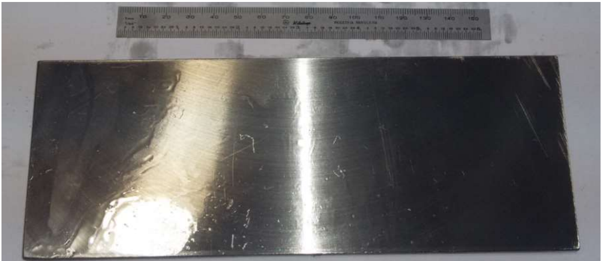
Figura 12 - Barra chata de aço inoxidável AISI 304 retificada.
