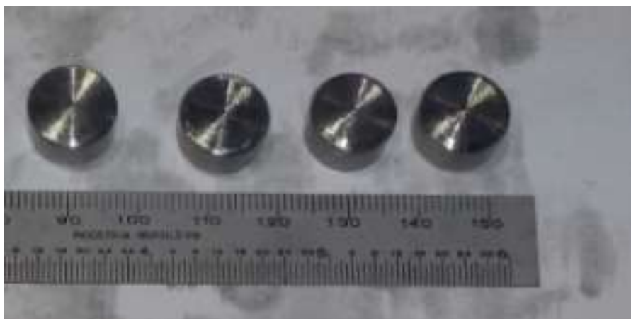
Figura 13 - Peças cilíndricas de aço inoxidável AISI 304 para análise por MEV.
