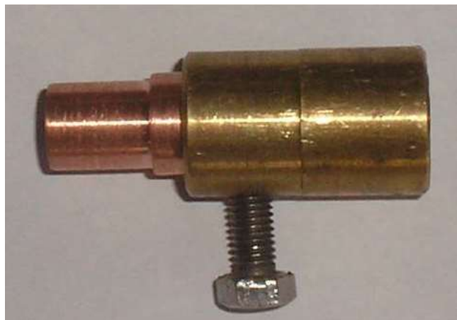
Figura 18 - Pinça de latão para fixação do eletrodo-ferramenta.
