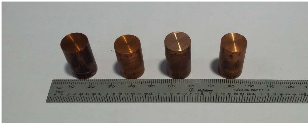
Figura 17 - Eletrodos-ferramenta de cobre eletrolítico \varnothing = 12 mm e comprimento de 30 mm.
