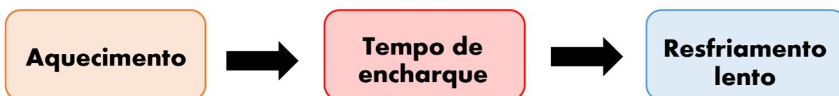
O tempo de encharque é função direta do grau de deformação. Em geral, quanto menor a deformação plástica inicial, maiores intervalos de tempo de encharque são requeridos para que ocorra recristalização completa e eficiente. O resfriamento acontece no interior do forno.
