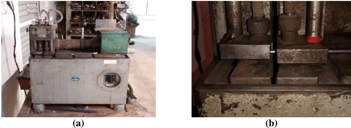
Cut off utilizado para cortar corpos de prova (a); e (b) detalhe da barra presa nos batentes da máquina.
