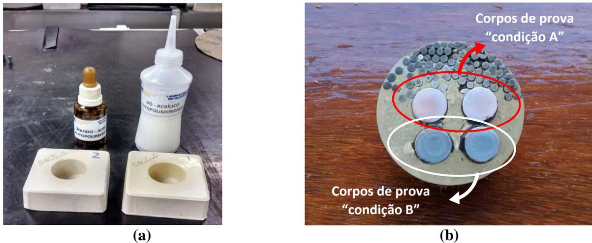
Resina acrílica de polimerização a frio e moldes para embutimento (a); e detalhe das amostras metalográficas – duas condições em duplicata por embutimento (b).
