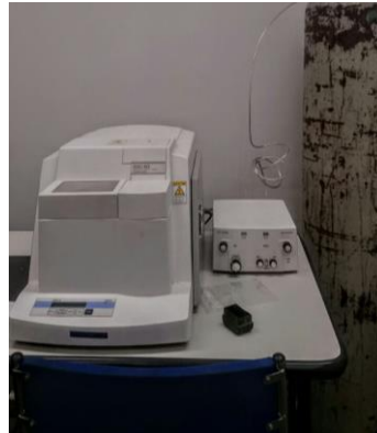
Figura 18 – Equipamento de calorimetria diferencial de varredura (DSC).
