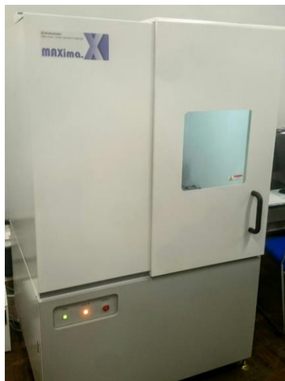
Figura 19 – Equipamento de difração de raios-X (DRX).
