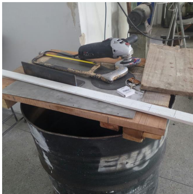
Figura 10 – Equipamentos de usinagem manual dos corpos de prova.
