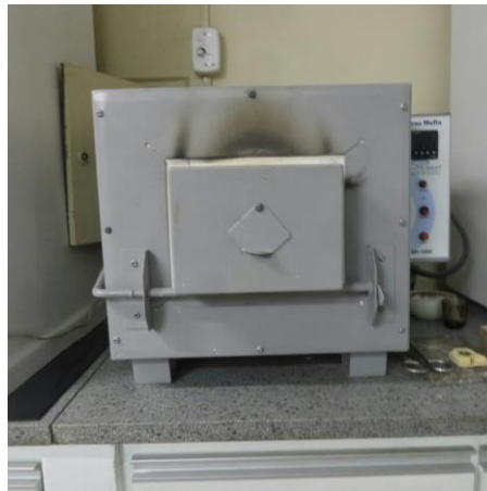
Figura 14 – Forno tipo mufla utilizado na determinação do teor de carga.
