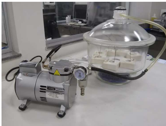
Figura 21 - Amostras soldadas em processo de embutimento a vácuo
