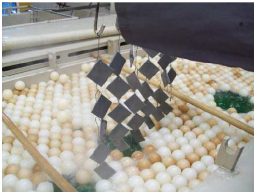
Figura 13 – Amostras enganchadas para deposição de NiP
