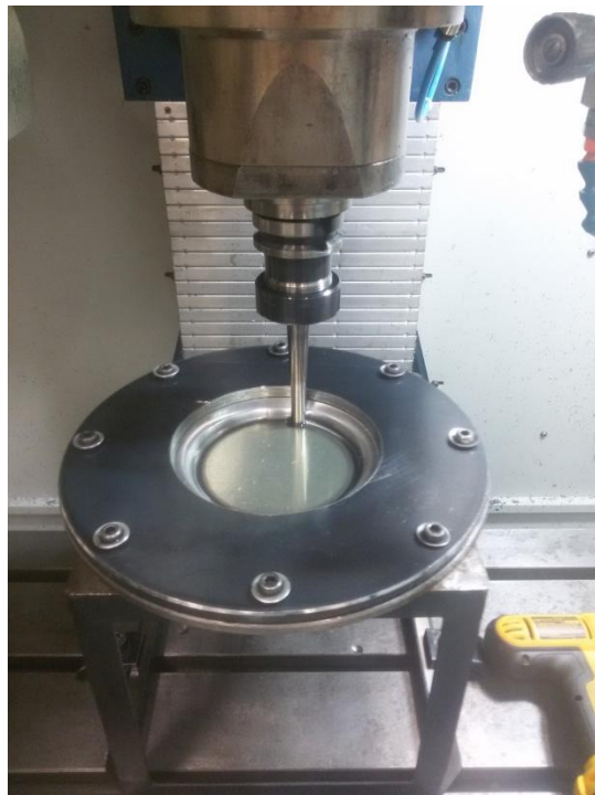
Figura 4 - Estampagem Incremental em um Centro de Usinagem CNC
