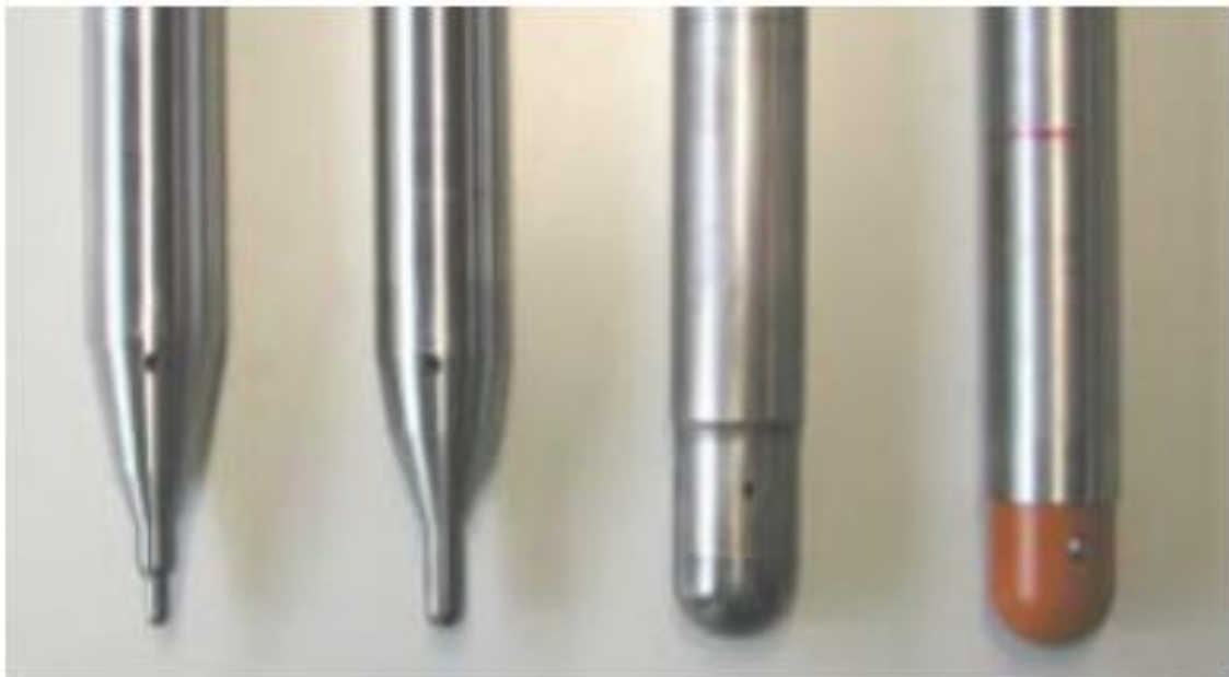
Figura 11 - Tipos de ferramentas com ponta de metal duro, e outra com ponta de plástico (à direita)
