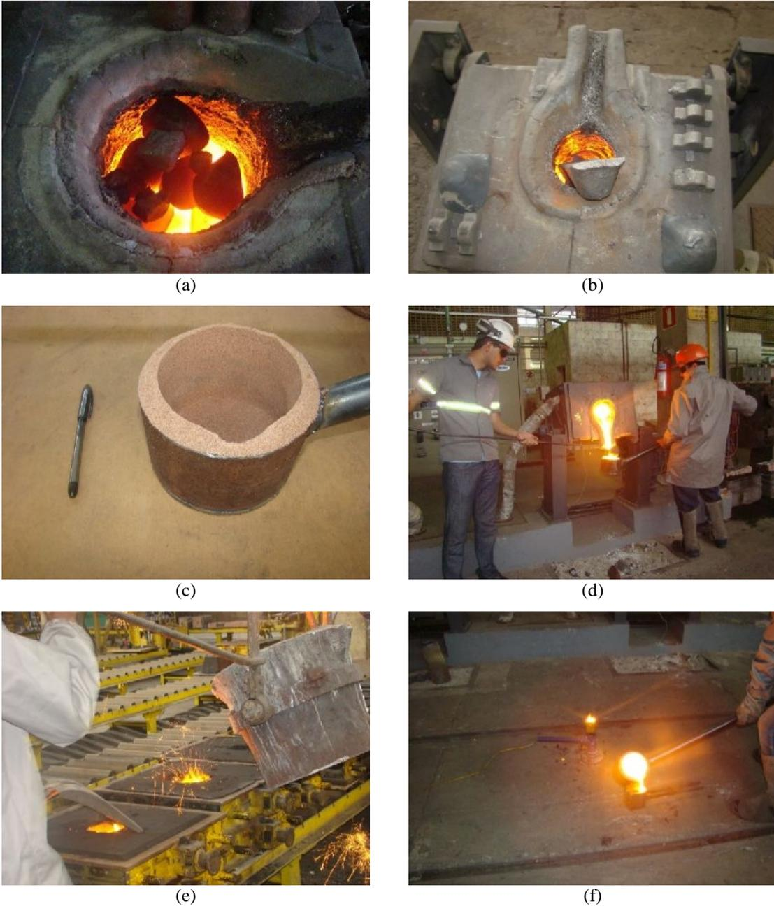
(a) Fusão dos lingotes para a obtenção da Liga Mãe no forno Cubilot; (b) Forno à indução para as Fusões 2 a 12; (c) Panela de 5 kg para transferência revestida com areia para diminuir o super resfriamento; (d) Transferência do ferro fundido do forno à indução de 25 kg para a panela de 12,5 kg; (e) Transferência do material para os moldes de ensaios mecânicos; (f) Transferência para os moldes de análise térmica e composição química. Fonte: Própria autora.
