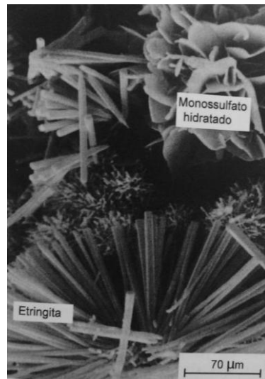
Figura 2 – Micrografia eletrônica de varredura de cristais hexagonais de monossulfato hidratado e cristais aciculares de etringita.
