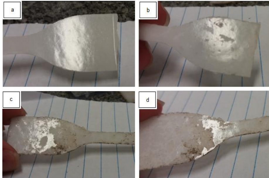
Figura 24 - Evolução da perda de brilho na superfície dos corpos de prova: (a) t_0 , (b) 3 semanas de ensaio, (c) 6 semanas de ensaio e (d) 9 semanas de ensaio.
