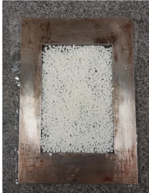
Figura 17 - Pellets de PBS distribuídos sobre o molde.
