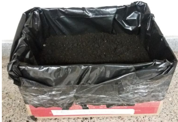
Figura 19 - Sistema para realização do ensaio de biodegradação.
