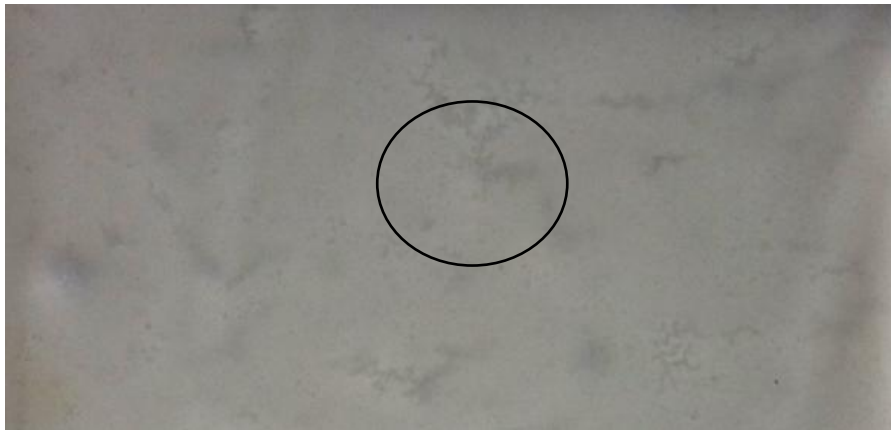
Figura 22 - “Estrias” em toda a extensão das placas de PBS.
