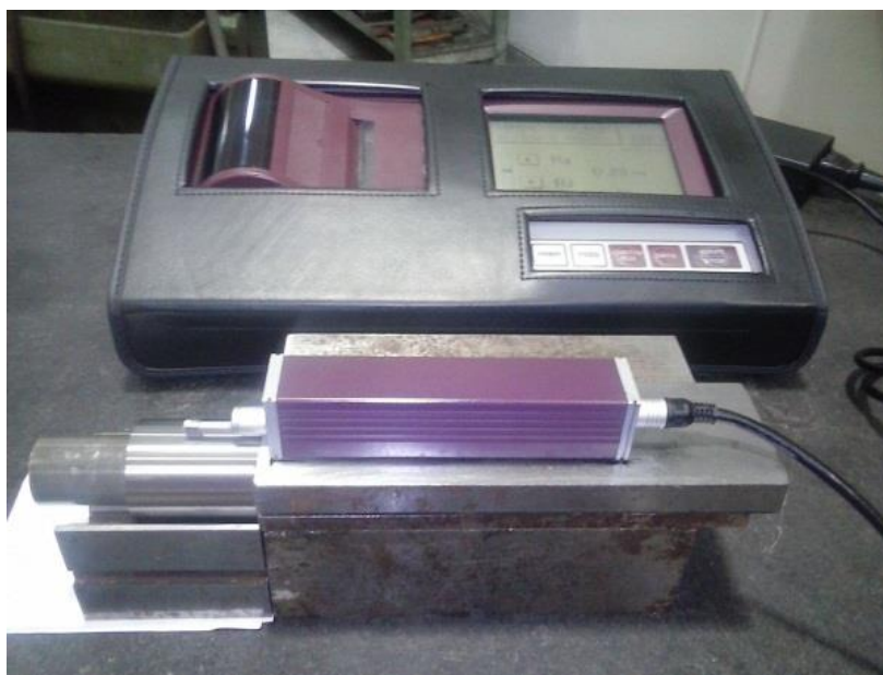
Figura 33 - Rugosímetro e os dispositivos usados para medição dos parâmetros avaliados.
