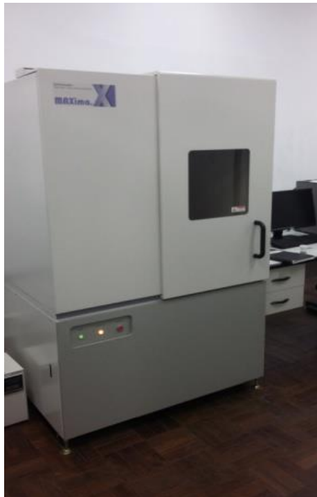
Figura 16 - Equipamento de DRX
