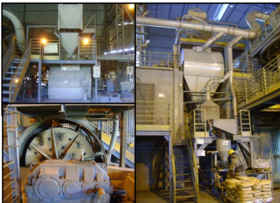
Figura 9 – Moinho a bola utilizado no projeto
