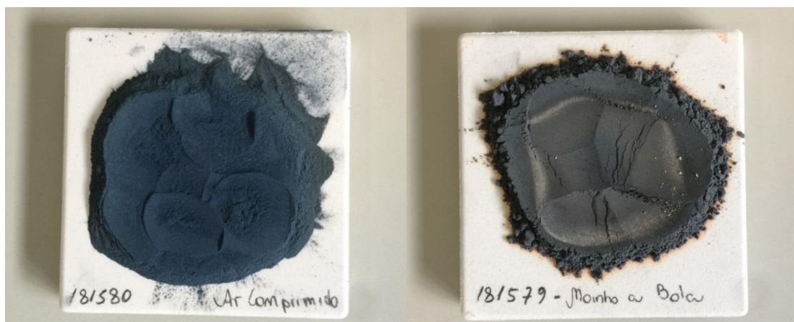
Figura 23 – Amostras de SiC após o teste de queima
